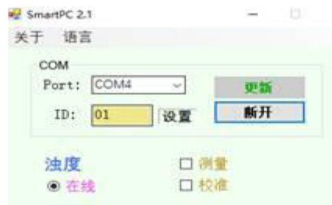
3. 勾选上图中的校准，就可以进行校准操作。按 F1 获取帮助文档。找到浊度探头校准说明即可。
